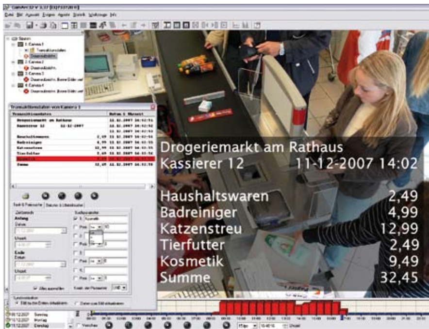
Bild 2: Die Kombination von Videoaufzeichnung und Transaktionsdaten klärt Unstimmigkeiten an der Kasse. Bilder: HeiTel
